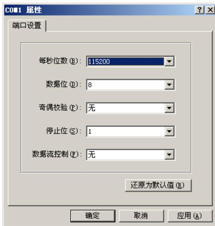
(10) 设置完连接的波特率后，单击超级终端菜单栏的[呼叫/呼叫]菜单项，重新建立超级终端和交换机的连接。
