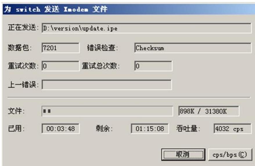
(14) 启动软件包下载完成后，系统提示用户设置该启动软件包的属性，即主用（M）、备用（B）或无属性（N）。键入<M>并回车，将所下载的软件包设置为主用启动软件包。
